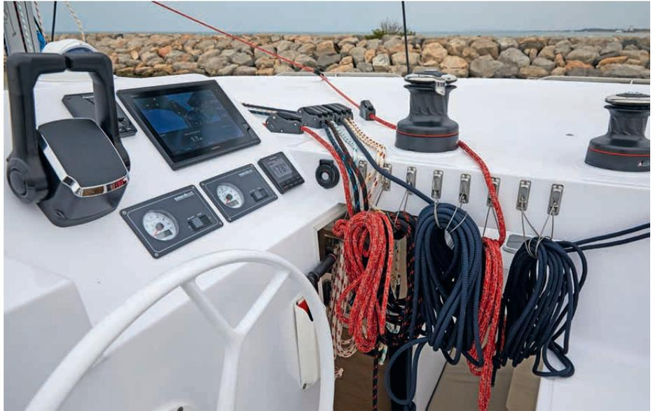
*Die konsequent zum Steuerstand geführten Schoten und Leinen lassen sich **AUCH IM ALLEINGANG** gut und einfach bedienen*
